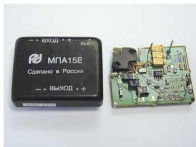
Одна из наиболее популярных серий DC/DC преобразователей. Сочетание высоких электрических параметров с малыми габаритными размерами и сравнительно низкой стоимостью определяют выбор покупателя при построении новых распределенных систем электропитания и модернизации существующих электронных устройств имеющих шину постоянного напряжения от 12В до 72В.
