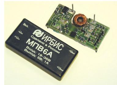
Серия МП.6 модулей питания представляет собой высокоэффективные 6 Вт преобразователи изготовленные с использованием технологии поверхностного монтажа на импортной элементной базе. Малые габариты и вес, низкий профиль, гальваническая развязка, высокая стабильность выходного напряжения, защита от перегрузки и короткого замыкания делают модуль незаменимым в системе распределенного питания
