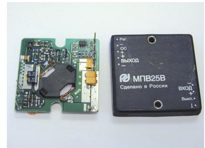
Серия МП.25 модулей питания представляет собой высокоэффективные 25 Вт преобразователи изготовленные с использованием технологии поверхностного монтажа на импортной элементной базе. Малые габариты и вес, низкий профиль, гальваническая развязка, высокая стабильность и возможность подстройки выходного напряжения, защита от перегрузки и короткого замыкания, компенсация падения напряжения на удаленной нагрузке делают модуль незаменимым в системе распределенного питания
